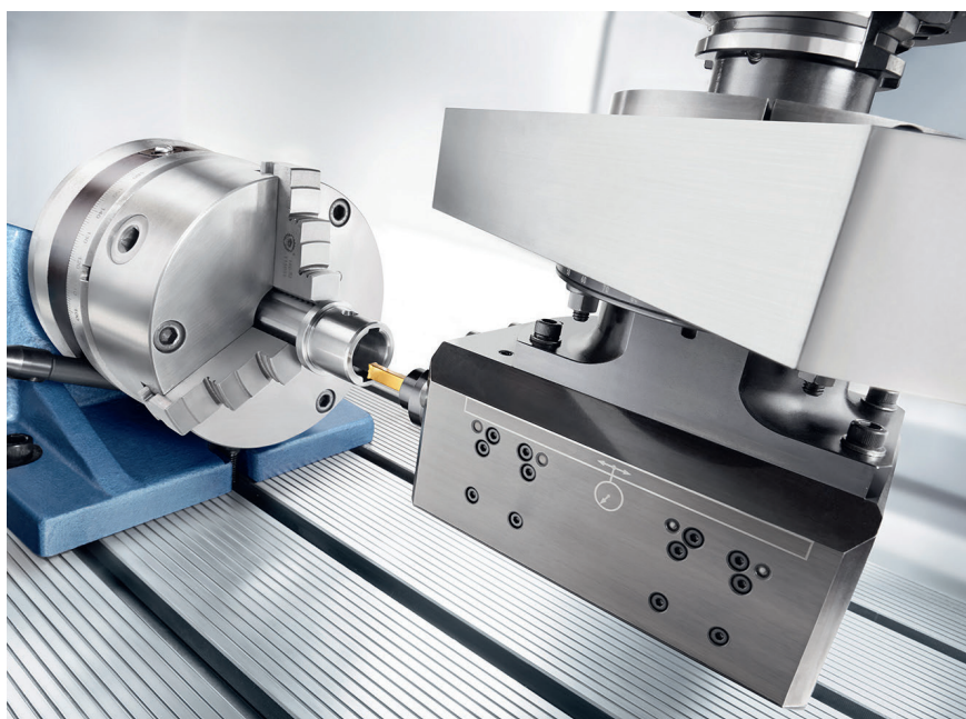
3 Clever: Stoßen auf einem Drehzentrum. Das Aggregat formt mithilfe eines Exzenters die Drehbewegung der Antriebswelle in eine Linearbewegung an der Antriebsseite um
