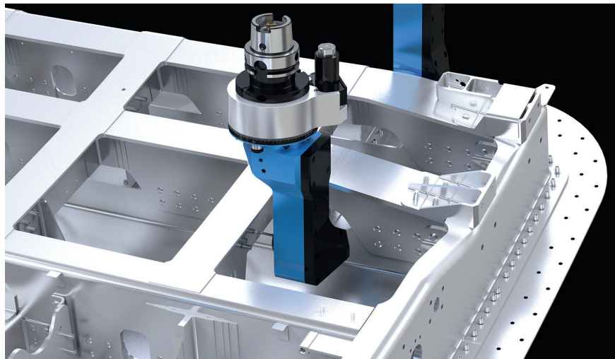
2 Kein Pardon für Ecken und Kanten: Bearbeitung einer Innentür mit einem Winkelkopf im Aircraft-Bereich (© Benz Tools)
